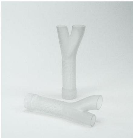
Loctite 3D IND405 Clear Teile, die mit dem Carbon DLS Prozess gedruckt wurden.
